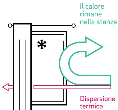
\* Finestra standard Requisiti minimi secondo l'Energieeinsparverordnung [Regolamento tedesco sul risparmio energetico] 2014 (EnEV):  $U_w = 1,3 \text{ W}/(\text{m}^2\text{K})$ , miglior valore SYNEGO con sistema a guarnizione centrale:  $U_w = 0,76 \text{ W}/(\text{m}^2\text{K})$
